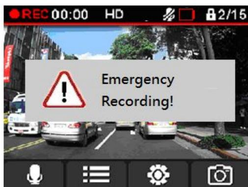
**碰撞事件录像：**在录像过程中，DrivePro 行车记录仪侦测到碰撞与撞击时，会自动启动「紧急录像」模式。
