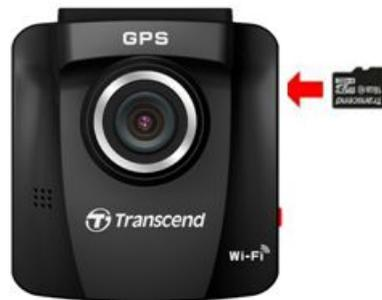
2. 欲将存储卡取出，请再按一次存储卡以弹出卡槽。
