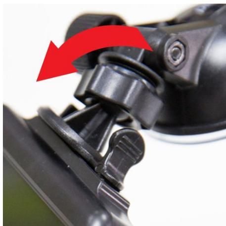
5. 当位置调整好，将环扣以顺时针方向转紧至最底部，确保 DrivePro 行车记录仪已完全固定。
