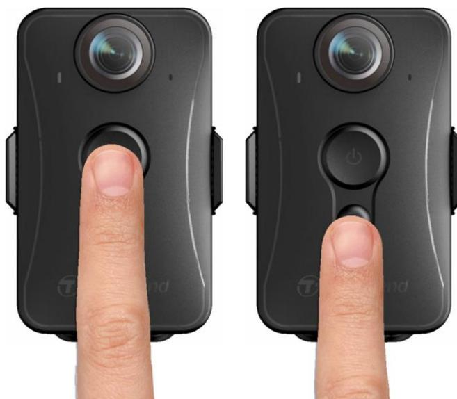
Примечание: DrivePro Body 20 останавливает запись при касании «Просмотр»/«Настройки» в интерфейсе мобильного приложения; при этом, включается синий фронтальный светодиодный индикатор.
